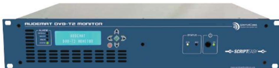
Slika 8.5 – Spoljašnji izgled Audemat DVB-T2 Monitor mernog (monitoring) uređaja, [40].
