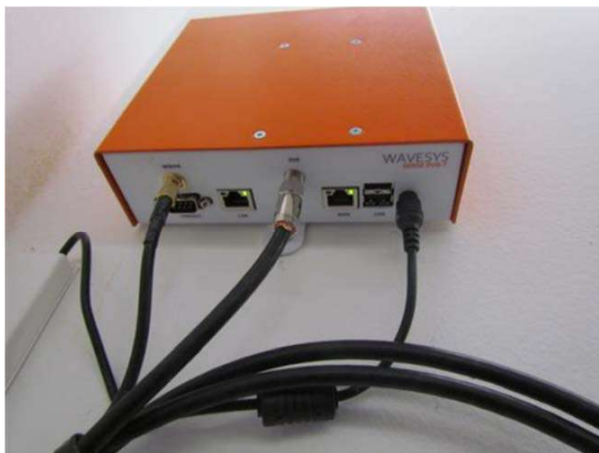
Slika 4.7 – Izgled i način povezivanja merne sonde, [32].
