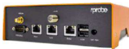
Slika 8.11 – Spoljni izgled rNode mernog uređaja, [43].
