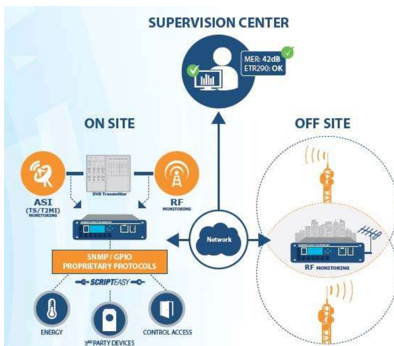
Slika 8.4 – Primena uređaja Audemat DVB-T2 Monitor u sistemu DTTB, [40].
