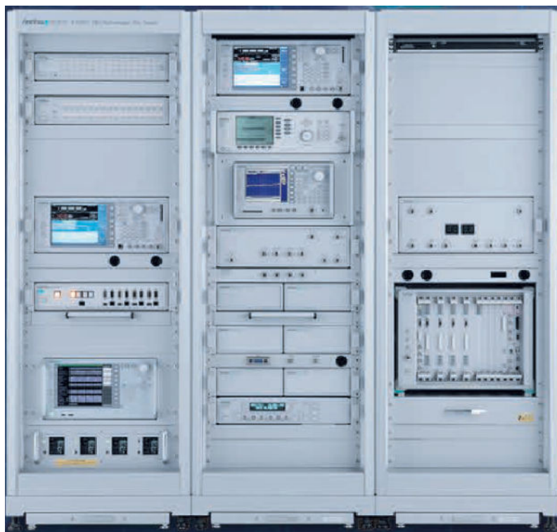
Slika 10.10: Izgled sistema za ispitivanje performansi W-CDMA UE – W-CDMA TRX/Performance Test System ME7873F i W-CDMA RRM Test system ME7873F.
