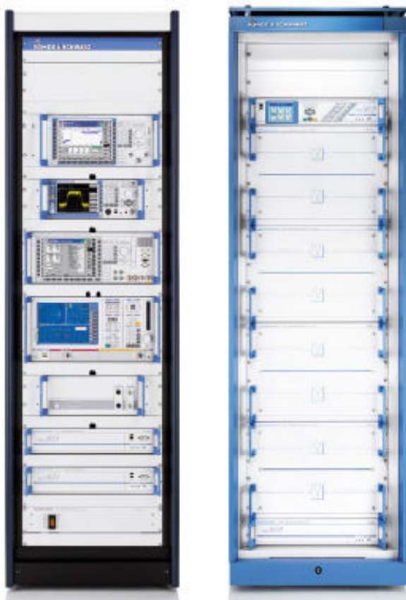
Slika 10.19: Izgled sistema za ispitivanje usaglašenosti sa EMC (EMI i EMS) zahtevima za bežične komunikacione uređaje R&S TS8996 RSE Test System .
