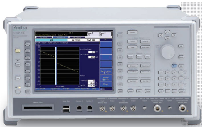
Slika 10.4: Prikaz sistema za analizu radio komunikacionih sistema Anritsu MT8820C .
