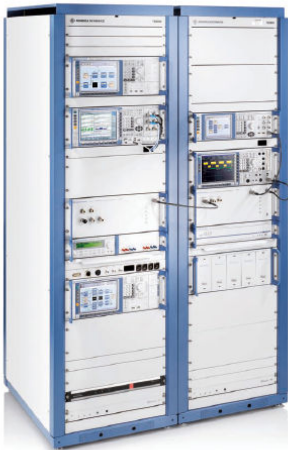
Slika 10.16: Izgled sistema za ispitivanje usaglašenosti korisničkih terminala ćelijskih mobilnih sistema R&S TS8980PRE RF/RRM Conformance Test System.
