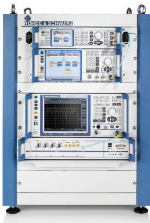
Slika 10.20: Izgled sistema za ispitivanje usaglašenosti sa zahtevima za bežične uređaje R&S TS8997 Regulatory Test System for Wireless Devices
