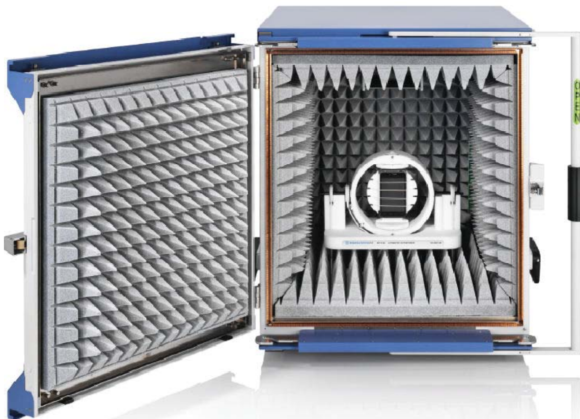
Slika 9.6: Rohde&Schwarz DST 200 RF dijagnostička potpuno anehoična komora
