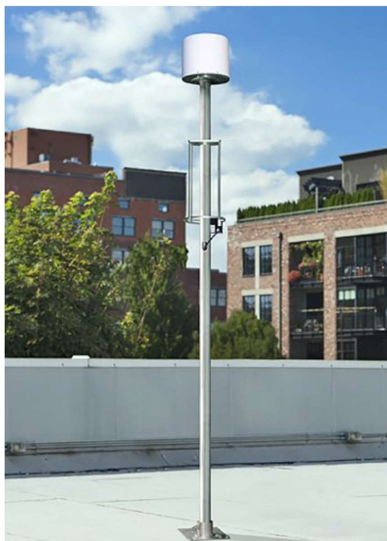
Slika 5.11 – Izgled monitoring antene TCI model 640H VHF/UHF/SHF primenjene u fiksnoj konfiguraciji monitoring antene
