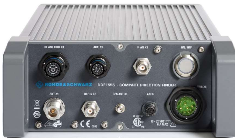
Slika 5.23 – Izgled DF uređaja R&S DDF1555.
