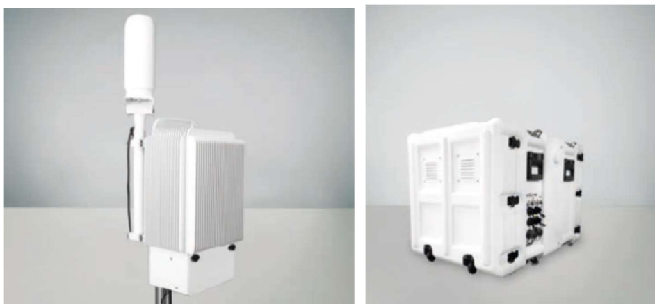
Slika 5.45 – Izgled FMU (levo) i TMU (desno) kao mernih stanica LS Observer sistema.
