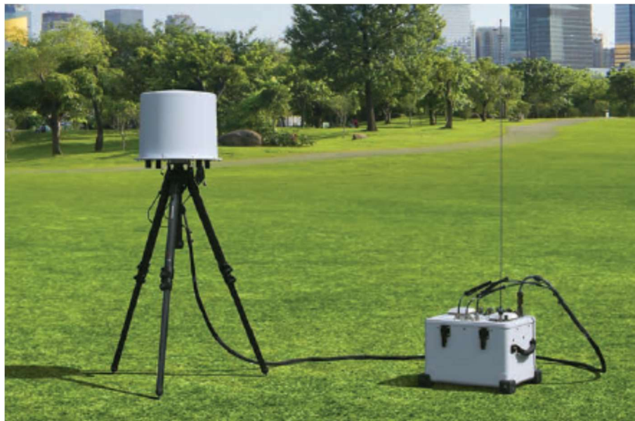
Slika 5.8 – Izgled prenosne merne stanice formirane uz primenu TCI model 733.
