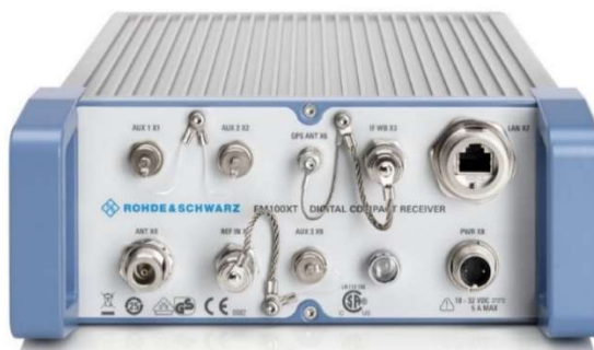
Slika 5.21 – Izgled mernog prijemnika R&amp;S EM100XT.
