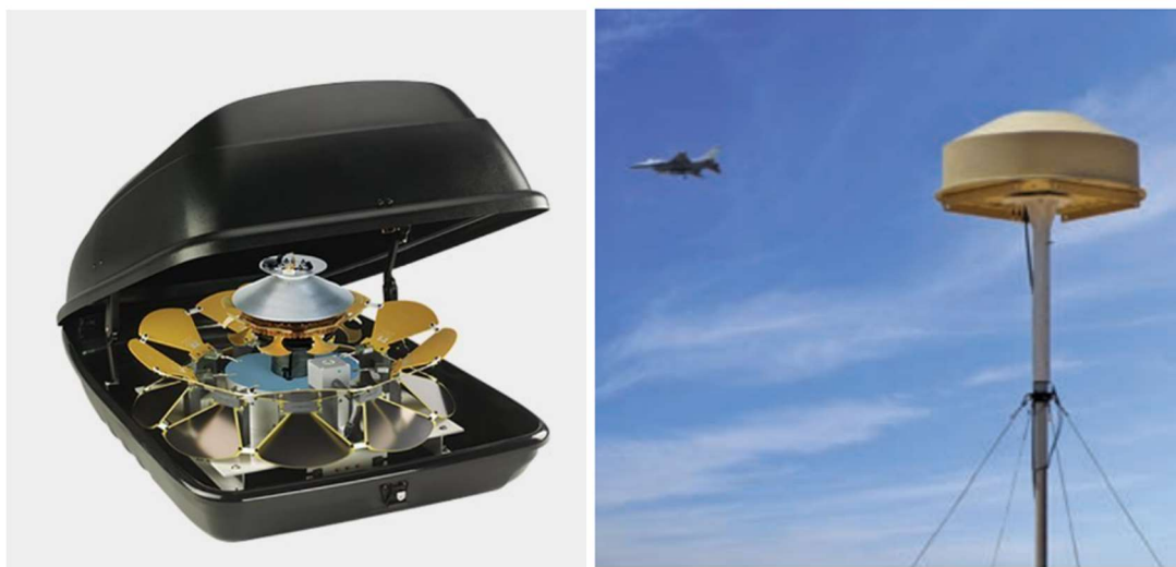
Slika 5.17 – Izgled VHF/UHF širokopojasne monitoring i DF antene TCI model 645-8.
