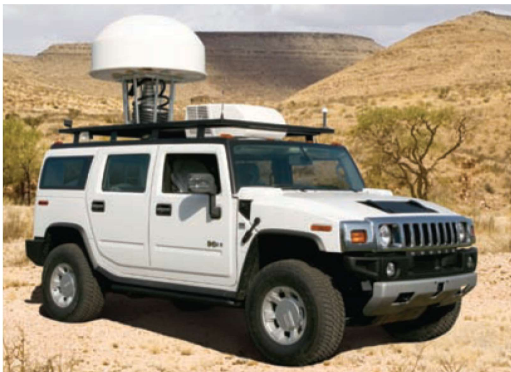
Slika 5.10 – Izgled mobilne merne stanice uz primenu TCI model 737.
