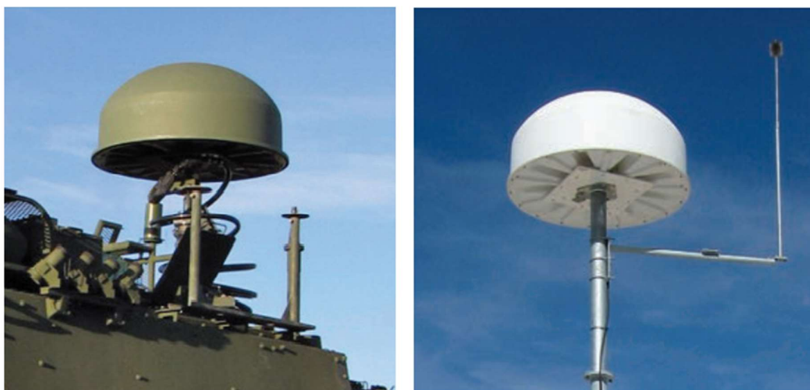
Slika 5.18 – Izgled VHF/UHF/SHF širokopojasne monitoring i DF antene TCI model 647.
