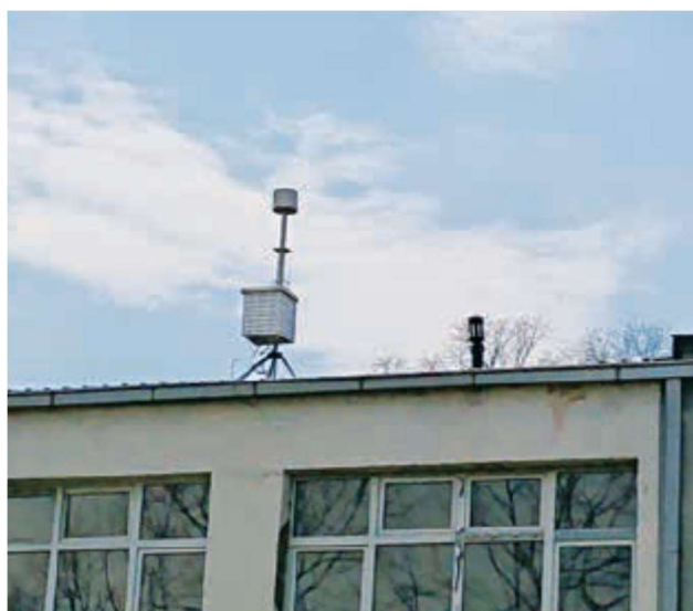
Sl.3.12 – Tipičan izgled CRFMS u okviru sistema za monitoring RF spektra u S. Makedoniji.
