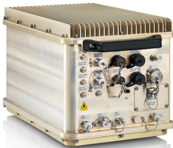
Slika 5.25 – Izgled CRFMS uređaja R&S UMS200 predviđenog za outdoor primene.
