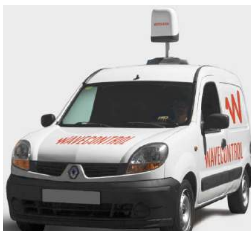
Slika 5.14 - Wavecontrol MapEM rešenje za mobilni senzor koje se lako instalira na vozilo uz pomoć magnetskog dodatka
