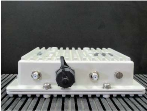
Sl.7.4.1 – Runcom 4G NLOS TVWS master/slave uređaj.
